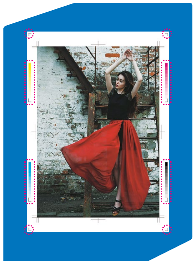
Автоматическая печать, сканирование и анализ меток привошки и градиентных шкал.
